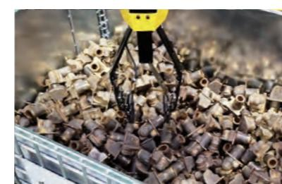
3Dマシンビジョンとバラ積みロボットアームにより
