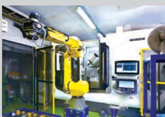
最新鋭5軸NC複合加工機「NTX 2000/1500SZM」と「NTX 1000 2nd Generation」(DMG MORI社製)に、高性能ロボットアームと自動搬入装置設備をセット。加工時間の長い小ロット品を自動切削加工します。ワークワンチャックで「主軸2台+5軸工具刃物台+ターレット刃物台」と同等の工程が無人で完了するため、生産効率と品質向上を実現できます。
