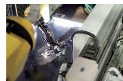
小ロット品の切削加工を実現する最新鋭5軸NC複合加工機×高性能ロボット。
