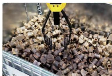
3Dマシンビジョンとバラ積みロボットアームにより
