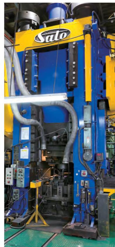
1000t プレス機と独自開発の精密ダイセットにより熱間中空鍛造による複数部品の一体化を実現。
