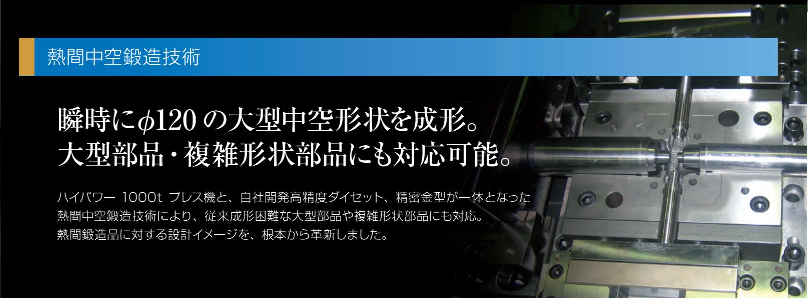
削出機械加工から熱間鍛造加工への転換で、大幅に省材料化・省切削化。
